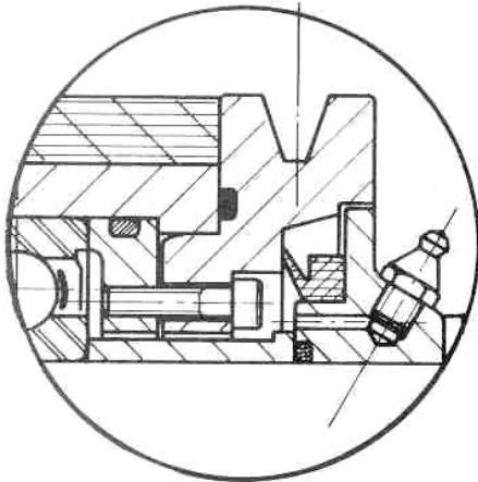
DETTAGLIO DELLA TENUTA A LABIRINTO CON INGRASSATORE DETAIL OF THE LABYRINTH SEAL WITH GREASE FITTING
